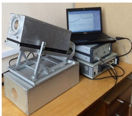
Рис.1. Левая панель: мобильный микроволновой озонметр ИПФ РАН с цифровым анализатором спектра, предназначенный для измерений профиля концентрации озона в диапазоне высот 20-70 км. Правая панель: спектр центральной части линии собственного излучения атмосферного озона, измеренный (красная линия) и модельный (синяя линия).
