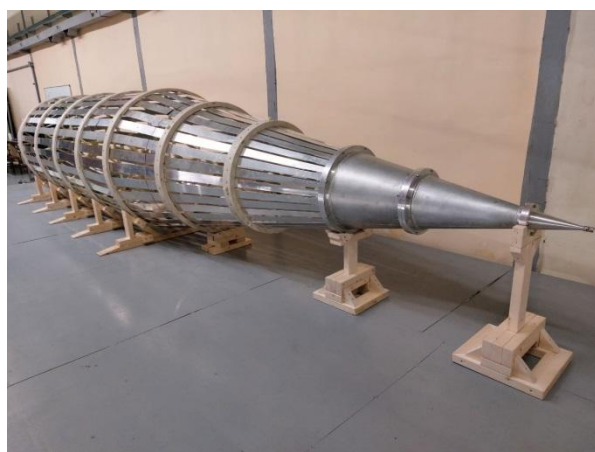
Рис.1. Фотография крупномасштабной коаксиальной линии (слева); фотографии свечения воздуха в передающей линии при прохождении мощных ЭМИ в зависимости от давления и периода повторения импульсов (справа).
